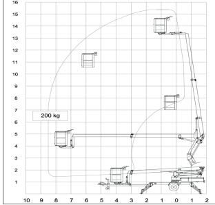
OMME 1550 EBZX wird von leistungsstarken Batterien, 24 V/165 Ah, angetrieben. Sie kann unabhängig von 230 V Netzspannung arbeiten.
